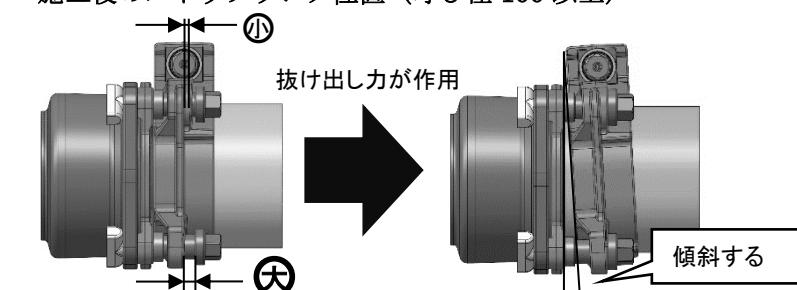
・ストップリングとストップナットのスキマは上側が小さく、下側が大きくなっています
