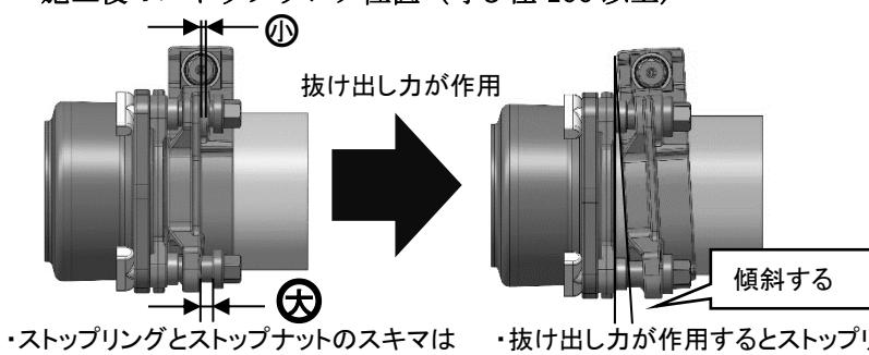
・ストップリングとストップナットのスキマは上側が小さく、下側が大きくなっています
