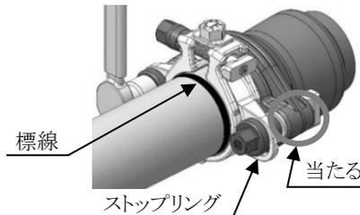
〔標線とストップリングのズレ許容寸法：10mm程度〕
