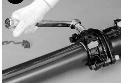
塩ビ管の場合はストップリングの先端があたるまで締付ナットを本締めして下さい。
