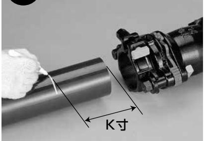
パイプ挿入量(K寸)を測り、標線を記入して下さい。
