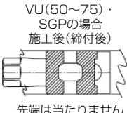
・ストップリング標準締付トルクを参照して下さい。
